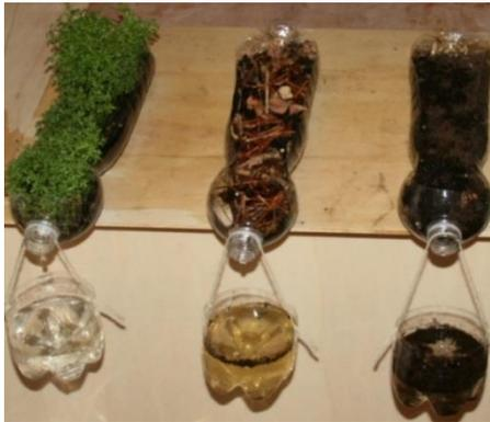
Gambar 4.5 Percobaan Erosi Tanah
