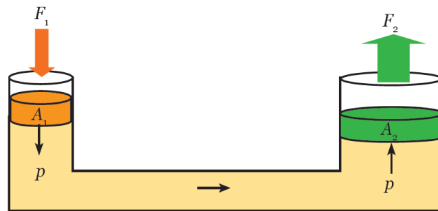
Gambar 1.8 Diagram Pompa Hidrolik
