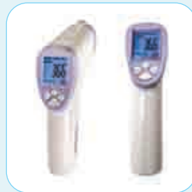
Gambar. 3.4 Termometer tembak untuk mengukur suhu dari jarak tertentu.
