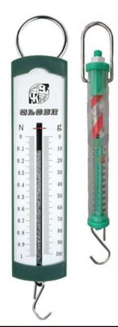
Nilai suatu gaya dapat diukur dengan alat neraca pegas atau dinamometer.
